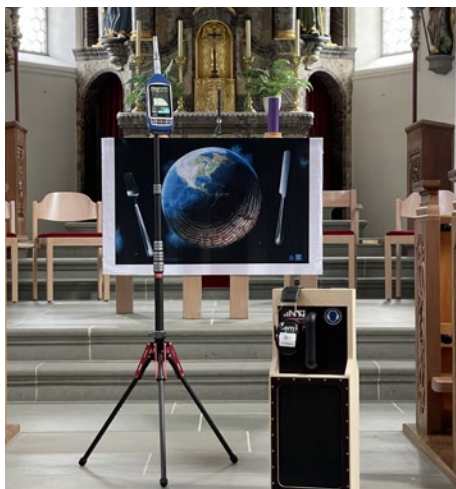
Modernes Messsystem zur präzisen und effizienten Erfassung der Akustik von Kirchenräumen.
